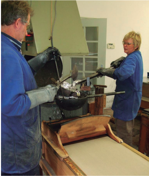
Haidy, trabalhando na firma Orgelbau Ahrend. Tubos são restaurados com estanho e chumbo e precisam ser feitos conforme o construtor idealizou
