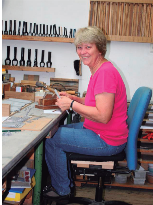
Haidy, trabalhando na firma Orgelbau Ahrend. Tubos são restaurados com estanho e chumbo e precisam ser feitos conforme o construtor idealizou
